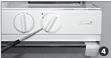
Laita nuppi takaisin paikalleen ja käännä nuppi seuraavaan nopeusasentoon ja irrota nuppi jälleen.
