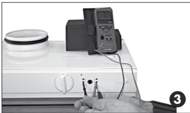
Mittaa jännite navoista - ja S, säädä esim. nopeus 1 potentiometrillä
