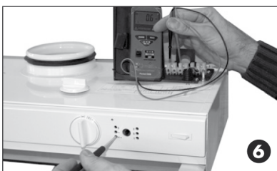
Voit tehdä mittauksen myös liittinrimalta, sähkökaavion osoittamista paikoista.
